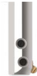
反向加工时刀片的起始位置
