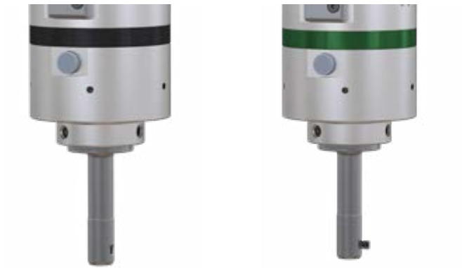
SOLO - 刀片在静止状态下(主轴停止)收回。它的最低运行工作速度为 1900 rpm。只有超过最低工作速度后，刀片才会伸展到工作位置。通过停止主轴来收回刀片。
